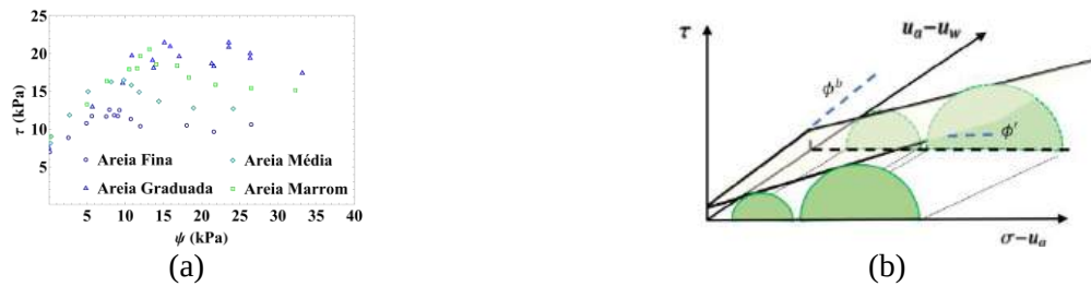
Figura 6. (a) Variação da resistência ao cisalhamento para areia de Brancaster (adaptada de Towner e Childs (1972)). (b) Envoltória de resistência de solos não saturados modelo de Fredlund et al. (1978).
